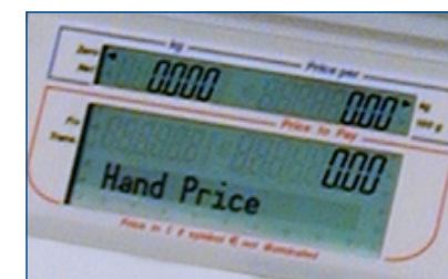
Standardmäßig wird eine reflektierende LCD verwendet. Optionale hinterleuchtete Versionen sind ebenfalls erhältlich.
